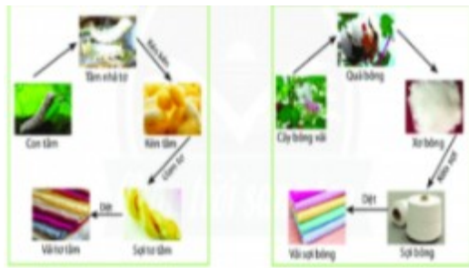
Hình 4.1. Sơ đồ quy trình sản xuất vải sợi thiên nhiên
