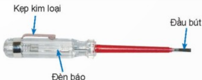
Hình 12.6. Cấu tạo của bút thử điện
