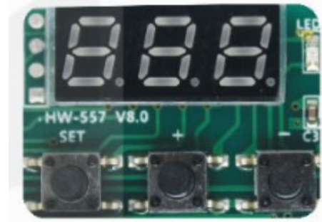
Hình 16.8. Màn hình hiển thị số và các nút cài đặt trên mô đun cảm biến nhiệt độ
