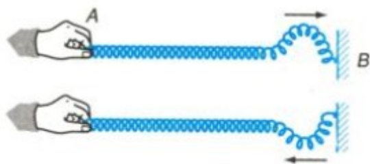
Hình 15.1 Biến dạng phản xạ trên lò xo đàn hồi một đầu cố định bị đổi chiều.
