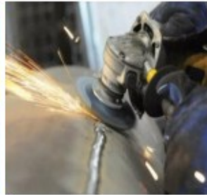
Hình 3: Mối hàn kim loại đang được mài nhẵn.
