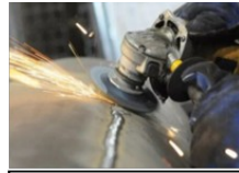
Hình 3: Mối hàn kim loại đang được mài nhẵn
