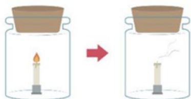
Mô phỏng thí nghiệm chứng minh nitrogen không duy trì sự cháy
