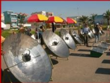
Bếp parabol – đun nấu bằng năng lượng mặt trời.
