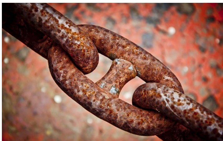
Hình 2: Sắt gỉ khi để lâu trong không khí
