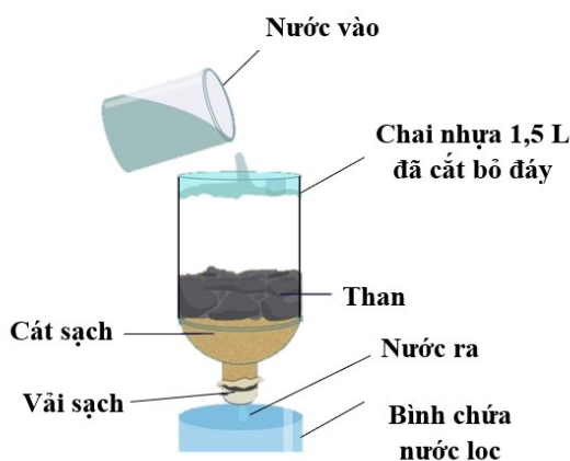
Sơ đồ 1. Sơ đồ thiết bị xử lý nước bằng than tồn tính làm từ vỏ trấu
