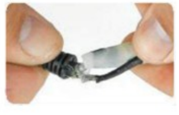
Hình 4: Dây điện bị sờn.
