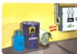
b) Chất đốt để gần tủ điện
