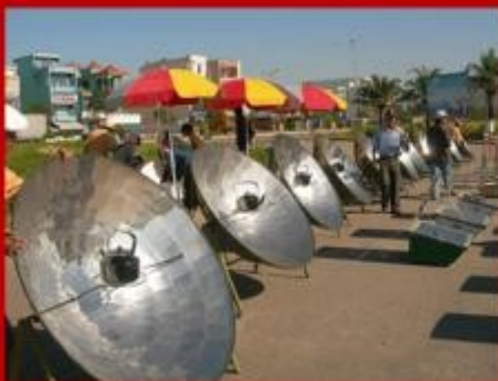
Bếp parabol – đun nấu bằng năng lượng mặt trời.
